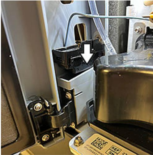
11. Instalar el tornillo (ver la flecha) en el lado izquierdo que sujeta la bandeja de drenaje.
