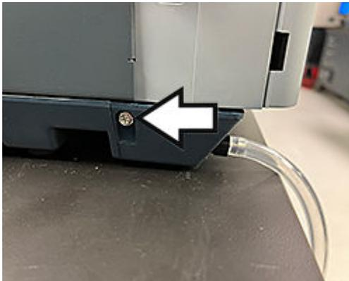
12. Volver a colocar los tubos del conducto de residuos (ver las flechas) en la cazoleta de drenaje.
