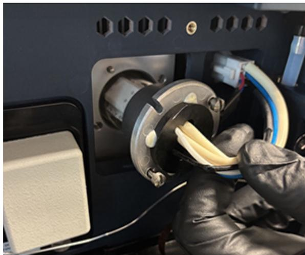
9. Colocar la lámpara nueva de modo que la muesca ubicada en la base de la lámpara esté en la posición de las 11 en punto, en línea con la clavija de alineación del alojamiento de la lámpara.
